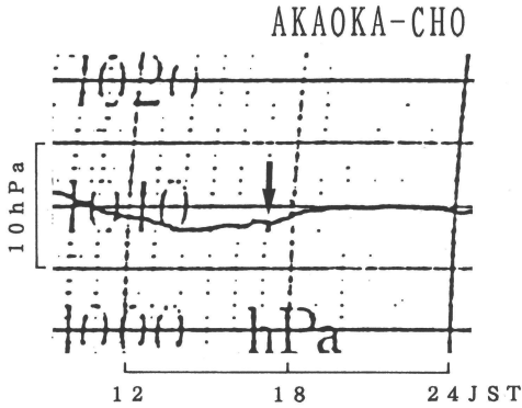
第3図 赤岡町香南消防署(第1図A2)における気圧変化(週巻き). 矢印が竜巻T1に伴う気圧降下を示す.
