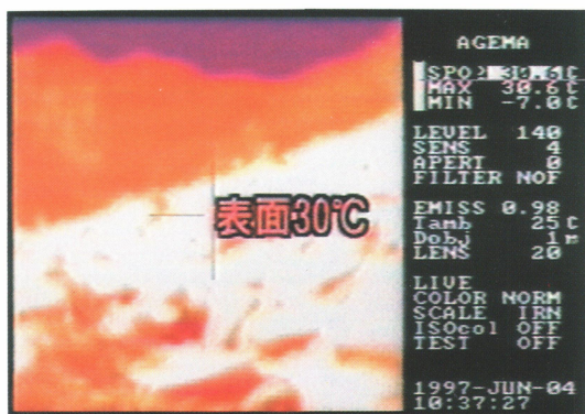
写真3 サーマグラフィーで撮影した崖錐表面の温度分布。白い部分は岩の上面で温度は30°C以上、青い部分は岩の下面で約1°Cの低温になっており、その風穴内部に氷が見られる。
