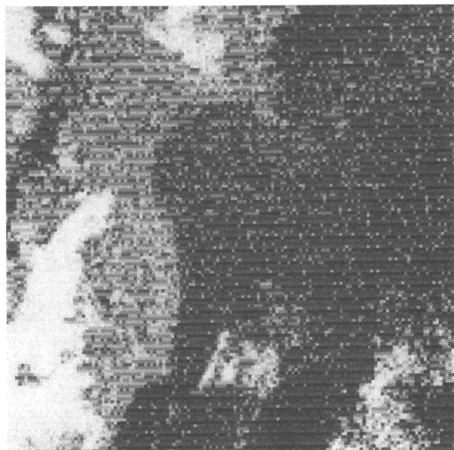
第1図 1996年10月30日7時(JST)のS-VISSR可視画像。日本・石巻湾付近。東西に方向の走査線に平行した横縞状のノイズが確認できる。
