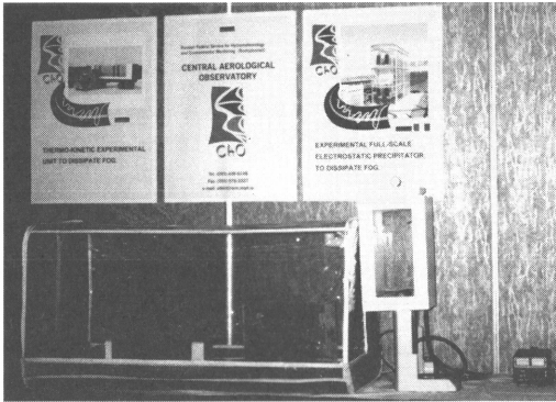
第5図 ロシア・中央高層気象台グループが出展していた高電圧によるコロナ放電を利用した消霧装置のミニチュア。
