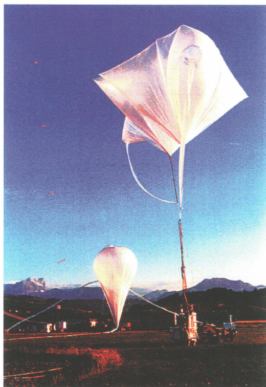
写真2 フランスでの気球実験で放球前の様子. 手前が補助気球につり下げられたゴンドラ, 後方が主気球.
