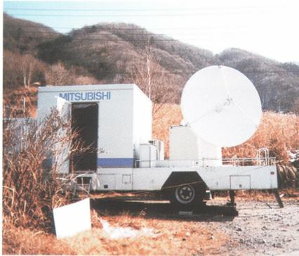
写真1 ミリ波レーダー 図右のアンテナから8.6 mmの波長の電波を出力100 kWで発射し、距離125 m、角度0.3°の分解能でデータを得る。図左の操作室には電波の送受信やデータの処理・記録のための装置が入っている。それらはトラックの荷台につけられており、移動が可能である。
