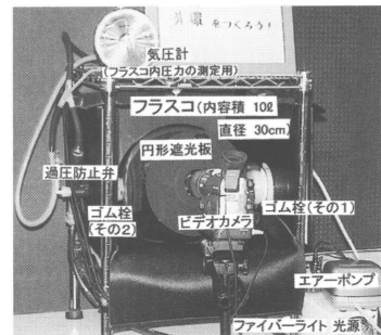
第2図 光環を作る装置
