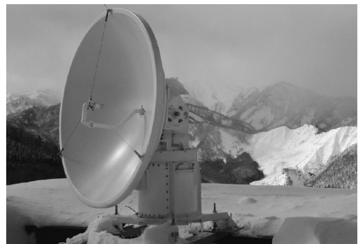
第3図 小型レーダー：アンテナとその下の台座（ベDESTAL）を分解して普通ワゴン車で運び、エレベータで11階建ての高層ビルの屋上へ搬入した。
