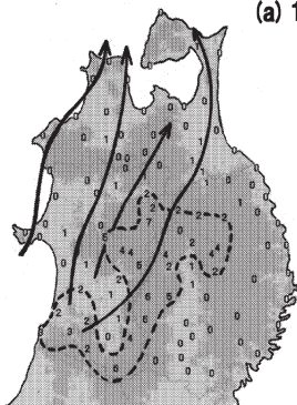
第10図 2000年4月23日の北東北での10時と14時の降水量分布。矢印は風系を、影部分は高度200 m以上の地域を示す。数字は1時間雨量(mm/h)で、ゼロは1 mm/h以下を示す。
