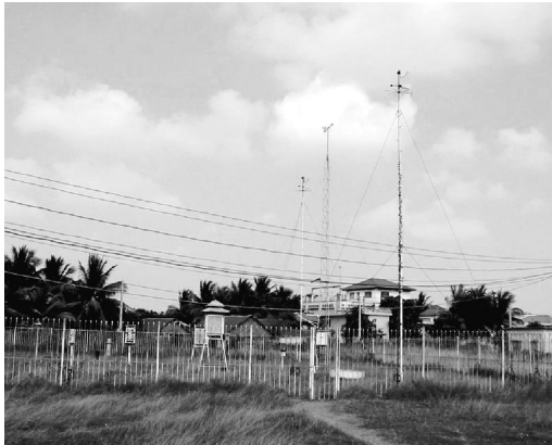
第2図 本局の気象観測露場。3本のポールのうち、右と左は旧ソ連の支援で建てられた風圧板型の風速計。
