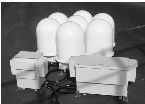
第8図 ルネベルグレンズアンテナを用いた最新型ウィンドプロファイラー。
