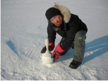
第1図 Ice Markerの概観と荻田による最北点(北緯78.72度, 西経104.79度)での設置状況. 筒の先端付近に気圧センサ, 球体の上部にGPSセンサ, 下部に温度センサが内蔵.
