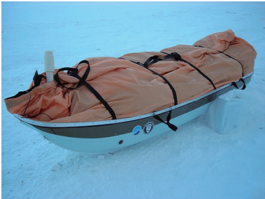
第2図 ソリ積載時のブイの配置状況. 位置・気象情報のデータ配信を行うため, ブイの先端のみ外気に露出.
