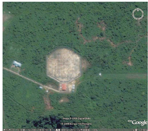
第7図 EAR は Google Earth から見ることもできる。中央の6角形状の土地は EAR のアンテナアレイ。赤屋根の建物が観測棟、散在する建屋の中に各種観測装置が設置されている。なお周辺の緑地はインドネシア政府により我々の地球大気研究のため確保されている。
