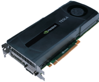
第1図 NVIDIA社製GPU搭載グラフィックス・ボード。
