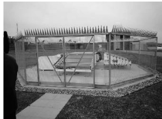
第3図 ウィンドプロファイラ。Degreane Horizon 製 PCL-1300ウィンドプロファイラ、使用周波数：1290 MHz、観測高度：75-8500 m。
