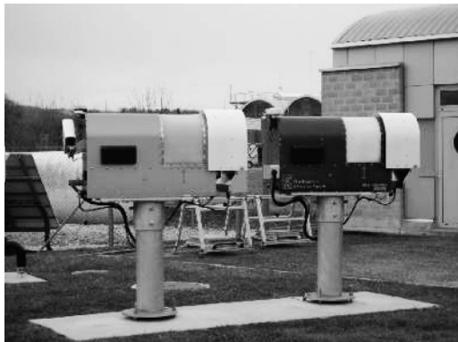
第4図 マイクロ波放射計。左：RPG社製 HATPRO，右：RPG社製 TEMPRO。
