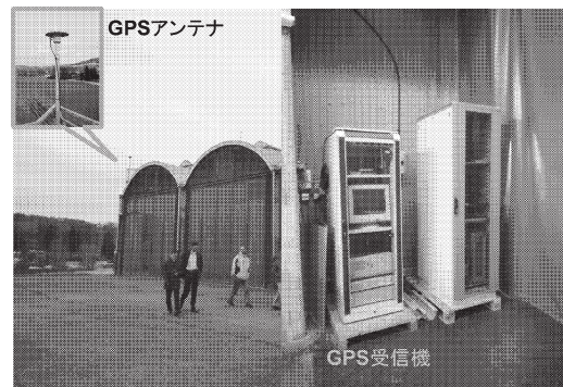
第2図 地上設置型GPS受信機 (可降水量)。
