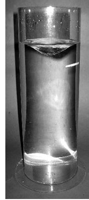
第3図 円筒形的水槽に渦巻きを作る。水面が凹んでいるので、渦巻きができていることが分かる。
