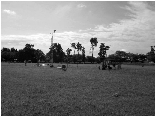
第1図 気象研究所露場の写真。南方向を望む。中央やや左側に見えるのが高度7.5 mの風速計，その左隣は温度差・湿度差の測定装置。
