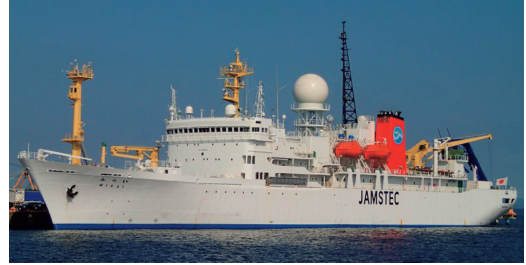
第1図 「みらい」全景。船体中央の球体が新レーダーのアンテナを格納するレドーム。2014年7月8日、(独)海洋研究開発機構横須賀本部から撮影。
