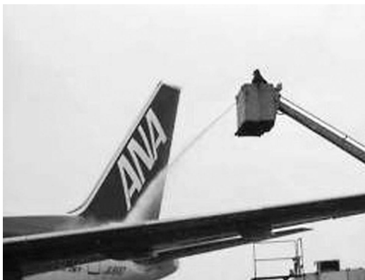
第6図 機体への防除氷液散布の様子。
