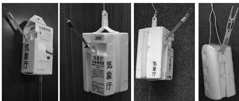
第12図 明星電気社製 GPS ゾンデ（提供：気象庁観測部観測課）。型名と大きさ（W×D×H、重量）は、左から順にRS-01G型（69×66×150 mm、約210 g）、RS-01GM型（89×85×215 mm、約160 g）、RS-06G型（98×88×155 mm、約150 g）、RS-11G型（86×67×154 mm、約85 g）である。
