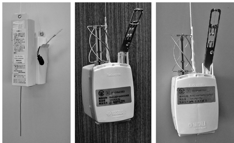
第14図 ヴァイサラ社製GPSゾンデ（提供：気象庁観測部観測課）。型名と大きさ（W×D×H、重量）は、左から順にRS80-15GA型（155×55×125 mm、約330 g）、RS92-AGP型（75×80×220 mm、約290 g）、RS92-SGP型（75×80×220 mm、約290 g）である。
