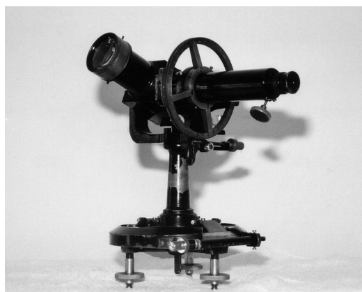
第15図 パイボール観測開始当時に使用された測風経緯儀。阿部（1997）掲載の写真6を転載。
