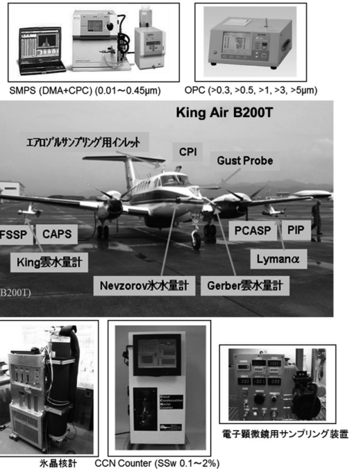
第4図 エアロゾル・雲・降水観測用航空機に搭載される測定装置。氷晶核計は気象研究所で開発 (Saito et al. 2011)。
