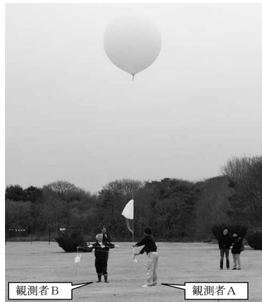
第2図 連結比較観測時の飛揚風景（2012年3月8日に岩渕真海氏撮影）。高層気象台（つくば市）における飛揚風景で、気球は1200gゴム気球を使用。写真中央の観測者Aが気球とパラシュートを支え、写真左側の観測者Bが比較ゾンデ1と比較ゾンデ2を取付けた連結棒を保持している。観測室からの指示により最初に観測者Aが気球を放し、その後観測者Bが吊紐の状況を見ながらタイミングを計って連結棒を放ち飛揚する。
