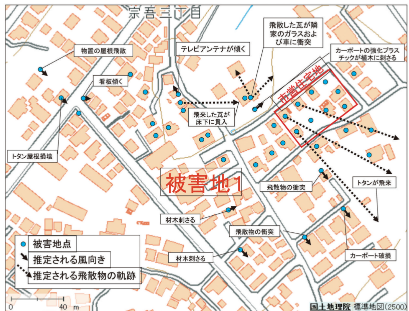
第16図 宗吾の被害地1の被害再調査をまとめたもの．薄い橙色の多角形は住宅．青色の点は被害のあった場所，青色の実線の矢印は被害状況からの推定による物の飛散した方向．青色の破線の矢印は目撃証言から推定した飛散物の軌跡．市営住宅地を赤色の四角で囲った．
