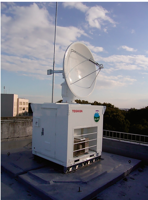
第1図 名古屋大学地球水循環研究センター (現 宇宙地球環境研究所) の X-バンド偏波レーダー。
