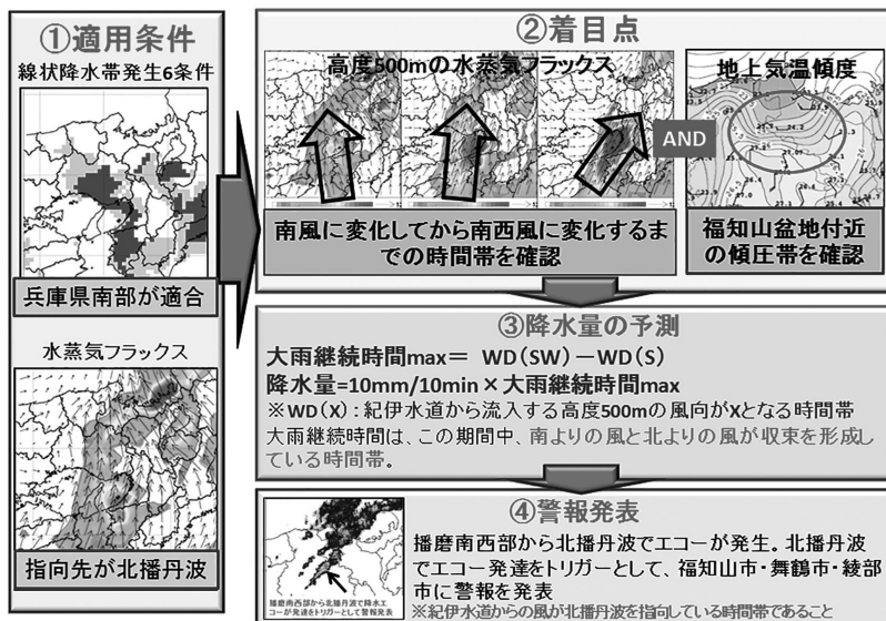
第2図 予報作業マニュアル（線状降水帯発生6条件：①ストームに相対的なヘリシティ（SREH） \geq 100 \text{ m}^2/\text{s}^2 ，②自由対流高度までの距離（500 m 高度） < 1000 \text{ m} ，③水蒸気フラックス量（500 m 高度） \geq 150 \text{ g}/\text{m}^2/\text{s} ，④湿度（500 hPa と700 hPa） \geq 60\% ，⑤上昇流（700 hPa，400 km 平均） \geq 0 \text{ m}/\text{s} ，⑥平衡高度（500 m 高度） \geq 3000 \text{ m} ）。
