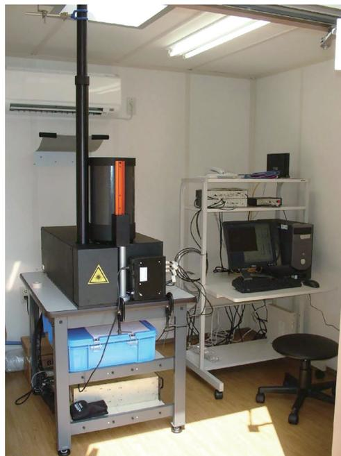
第2図 AD-Netの標準的なライダー装置の写真。左側が送受信部で、円筒形のものが受信望遠鏡（口径20 cm）。その隣のパイプを通してレーザーが上空に発射される。右側はデータ収集装置と制御用のコンピュータ。
