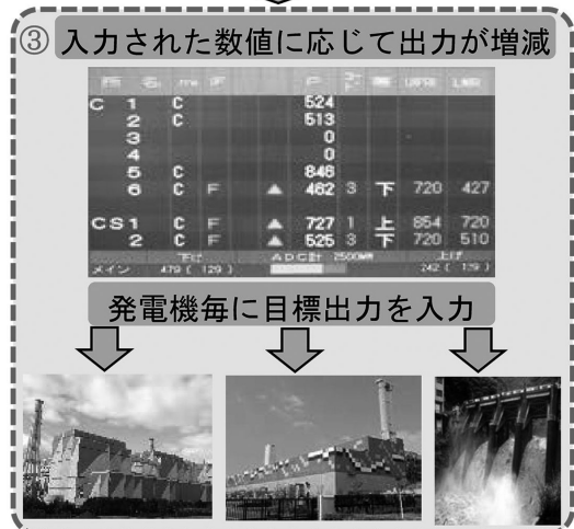
第4図 水力・火力などの出力調整可能な発電機で調整。
