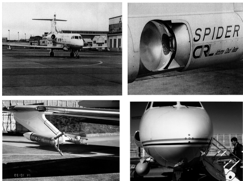
第2図 観測用航空機 G-II とその搭載観測機器。左上：G-II の全体，右上：航空機搭載型雲レーダ，左下：翼端の雲物理プローブ，2 DP（降水粒子測定プローブ）と2 DC（雲粒子測定プローブ），右下：レドームを改修した5孔ガストプローブ。
