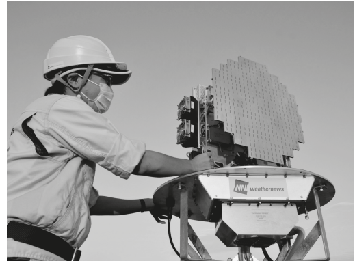
第3図 ウェザーニューズが独自に開発・運用を行っている高頻度観測小型気象レーダー「EAGLE レーダー」。
