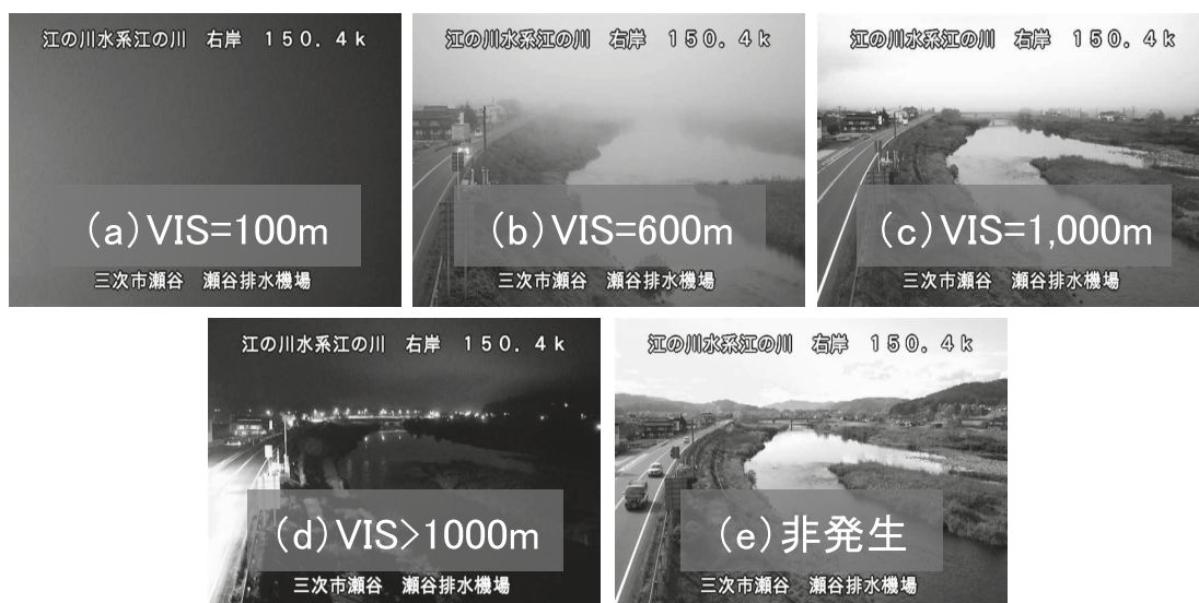
第4図 教師画像に使用した三次市瀬谷にある河川ライブカメラ画像（ http://www.cgr.mlit.go.jp/miyoshi/ ）の例。(a) 100m 未満, (b) 100～600m, (c) 600～1,000m, (d) 1,000m 以遠, (e) 非発生 の 5 クラスに視程 (VIS) を分類した。
