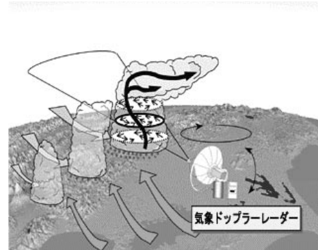
図2 集中豪雨の監視・予測精度の向上に威力を発揮する気象ドップラーレーダー
