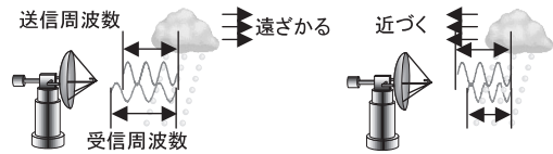
図3 ドップラーレーダーの観測原理 ドップラー効果により雨雲が遠ざかる場合には受信周波数が低くなり、近づく場合には周波数が高くなる(波長は遠ざかるとき長くなり、近づく場合に短くなる)
