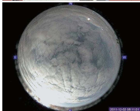
図5 全天雲量測定器と取得された画像
