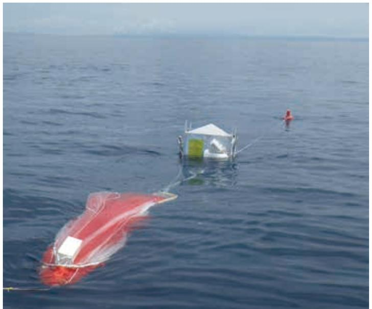
写真2 高速ボートに乗船したゴンドラ回収班が海上で発見したゴンドラ。手前にパラシュート、奥にイリジウムブイがある。（宇宙研・池田氏提供）
