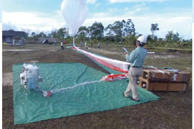
写真1 ピアク島のLAPANの敷地で行われた大気球の放球作業の様子。奥にヘリウム充填中の気球本体、手前左手にゴンドラ（JTサンプラー）がある。（北海道大学・稲飯氏提供）
